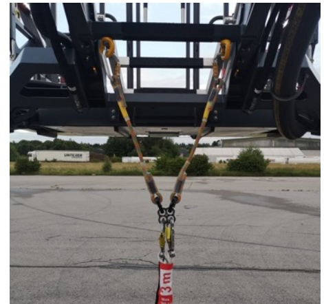
Y-Adapter für die Leiterspitze an Rosenbauer Drehleitern um die Kräfte gleichmäßig zu verteilen
