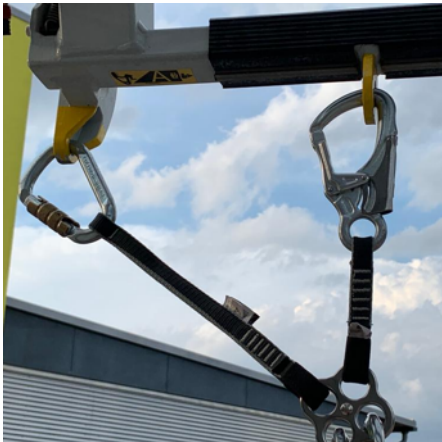
Einhängen des Leiteradapters (Magirus CS Baureihe)
